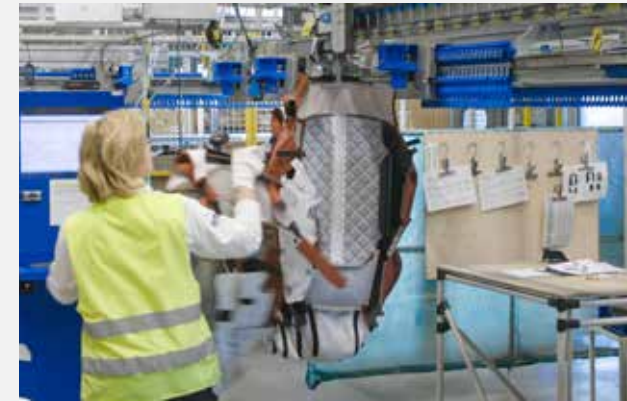
Wareneingang: Aufklammern, Scannen und automatische Beladung der Bezüge
