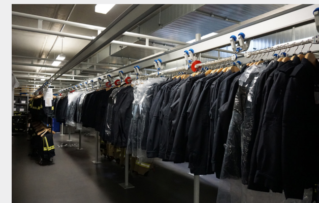
Einfaches „Ziehen“ der Schutzkleidung über das Schienensystem statt schweres Heben
